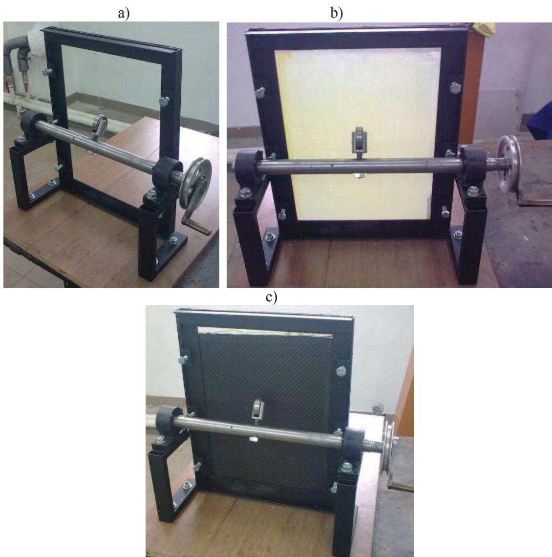
Rys. 5. Widok wykonanego stanowiska a) bez badanej płyty, b) płyta włókno szklane, c) włókno kevlar
