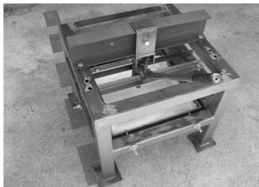
Rys.7. Wykonane stanowisko z zamocowanym laminatem z włókna szklanego
