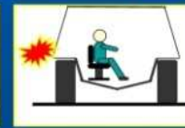
Rys. 4 Wymagania minoodporności oraz odłamkoodporności pojazdów według umowy standardyzacyjnej STANAG 4569
