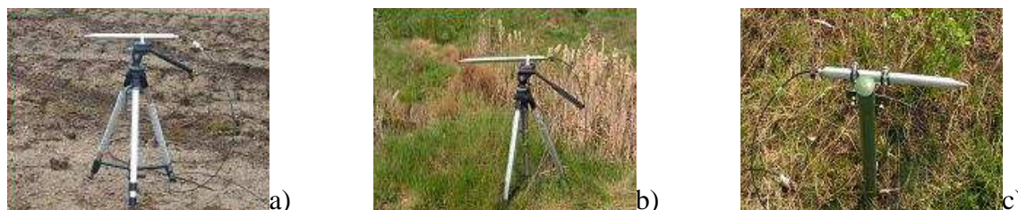
Rys. 4. Czujniki ciśnienia PCB Piezotronics Inc. serii 138a zastosowane w badaniach doświadczalnych do identyfikacji parametrów fali uderzeniowej wybuchu
