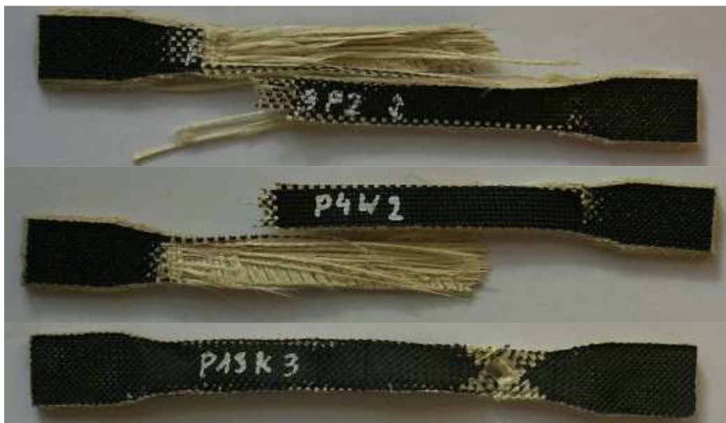
Rys.2. Próbki po zerwaniu Fig.2.Break of test piece
