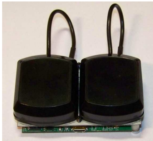
Rys.3. Widok układu z zamontowanymi antenami
