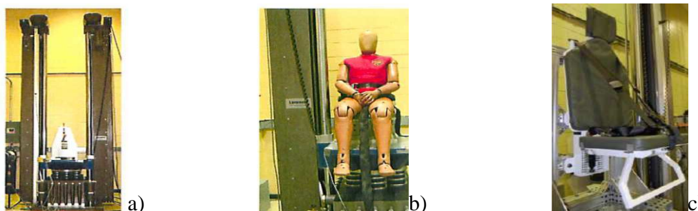
Rys. 4 Przykłady stanowisk labotoratoryjnych: a) uderzenia pionowe, b) uderzenie bokiem c) uderzenie bokiem wraz z siedzeniem firmy Allen Vanguard [1, 2, 6]
