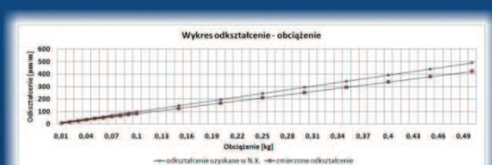
Wykres przedstawiający odkształcenia zginanej belki w funkcji obciążenia
