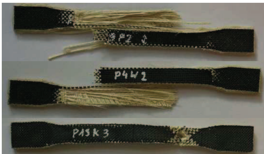
Rys.2. Próbki po zerwaniu Fig.2.Break of test piece
