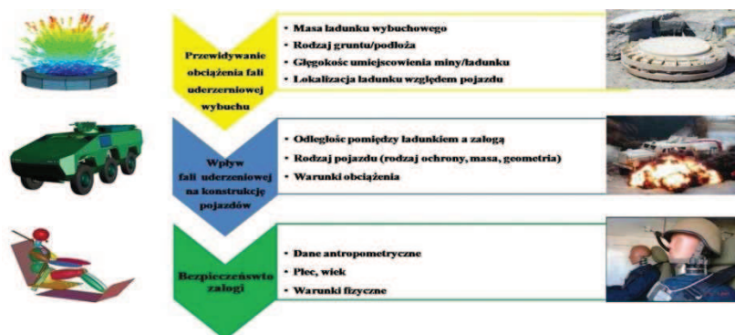
Rys. 2. Parametry wpływające na stopień zagrożenia załogi pojazdów wojskowych Fig. 2 The parameters affecting the degree of danger the crew of military vehicles
